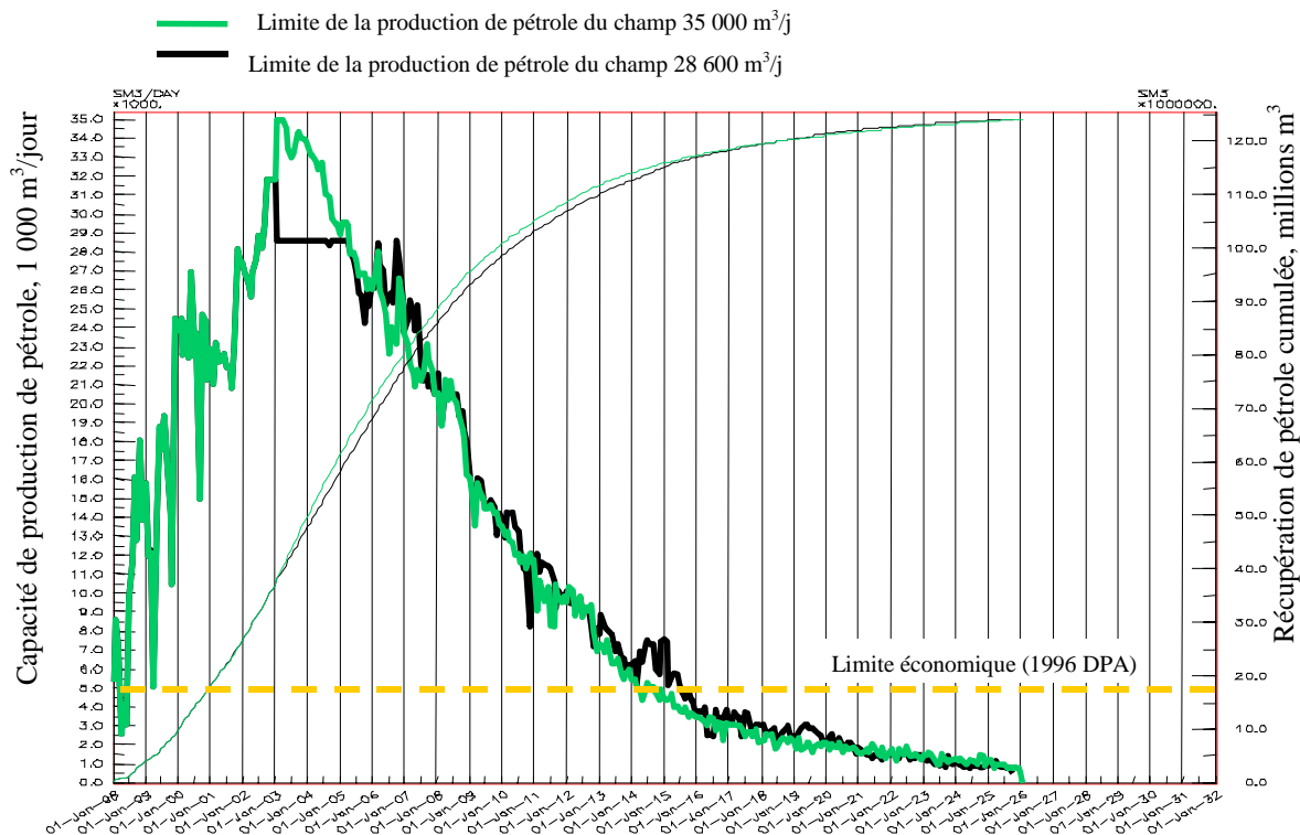
Figure 7 : Comparaison des productions et récupérations du pétrole du champ dans les cas de sensibilité aux taux : scénario « exploitation d’Hibernia, si l’on ne poursuit pas l’exploitation de BNA » (Source: d’après HMDC 2002)
