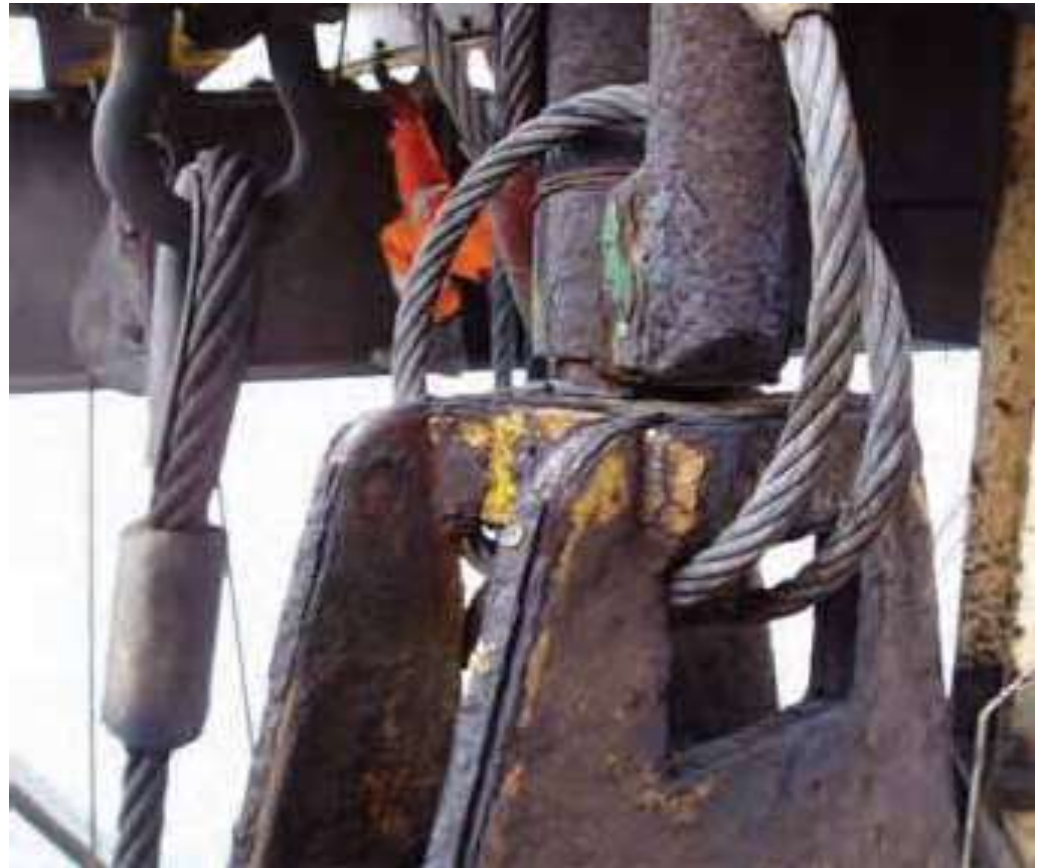
Équipement de levage mal entretenu
