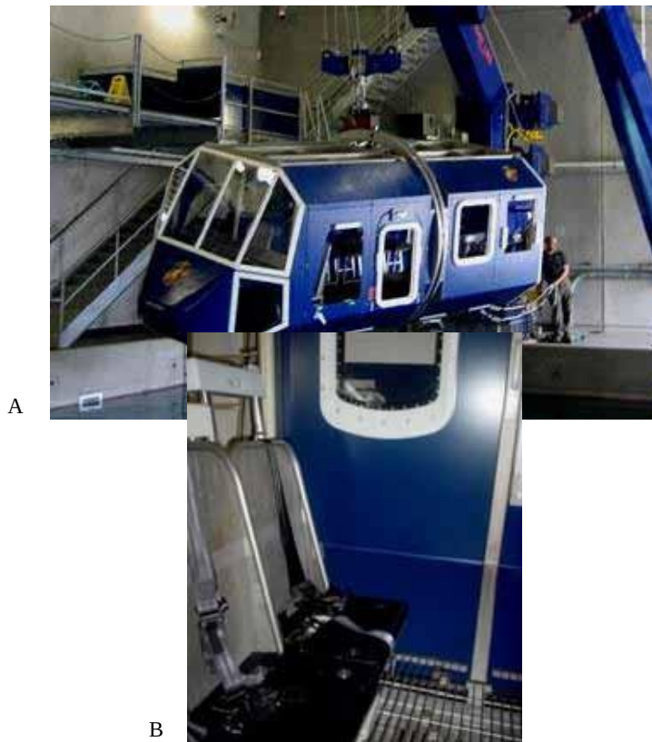
Figure 8. Modèle METS MC 40 montrant 4 types de sortie différents (image A). Intérieur du METS MC montrant des sièges à haut dossier résistant aux chocs entièrement compressés et des harnais à 4 points (image B).
