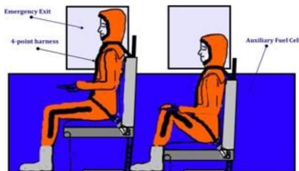
Figure 1. Siège résistant aux chocs en position haute (avant l'impact) et en position comprimée (après l'impact).
