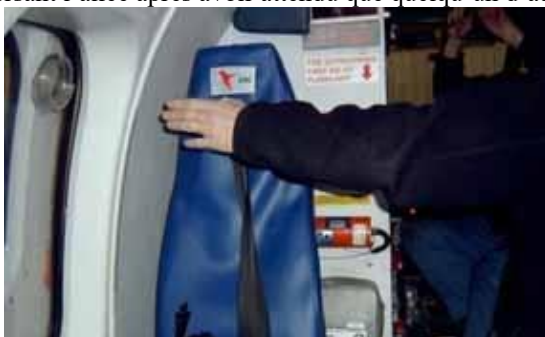
Figure 5. Siège passager avant de l'AS332L du réservoir de carburant auxiliaire. (Remarque : le passager doit sortir en traversant l'allée).
